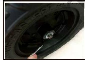
4. Inserta el pasador en el orificio del eje y gírelo para que no se suelte la rueda.
