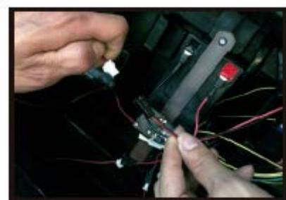
Primero coloque las luces tal y como se muestra en la imagen. Luego pase los cables por el agujero para poder conectarlo a la batería. El cable rojo con el borne rojo y el cable negro con el borne negro.
