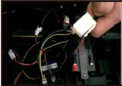
Conectar el cable rojo con el borne rojo de la batería y el cable negro con el borne negro de la batería
