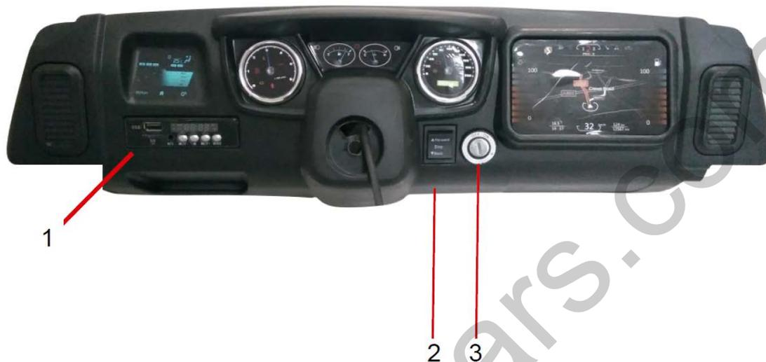
1. USB, Tarjeta SD, Radio, Siguiete Canción, Volumen, Indicador de voltaje
