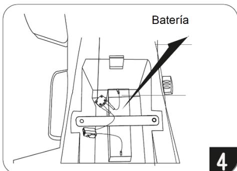
Levante el asiento y conecte los cables de la batería. El cable negro con el negro y el rojo con el rojo.
