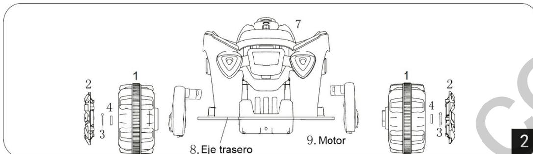
En primer lugar coloque un motor en ambos extremos del eje trasero.
