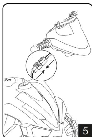
Conecte los cables que tiene el manillar con los que salen del orificio de dirección tal y como se muestra en las imágenes.
