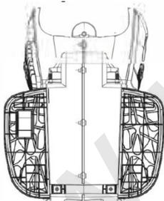
Primero conecte los pedales al vehículo. Para ello conecte el terminal rojo con el interruptor rojo.
