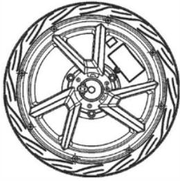
Quite la pastilla de freno electrónica de la rueda delantera, abra el compartimento de las pilas, instale dos pilas AA de 1,5V y fijela nuevamente con un tornillo, luego sujete la pastilla de freno electrónica.
