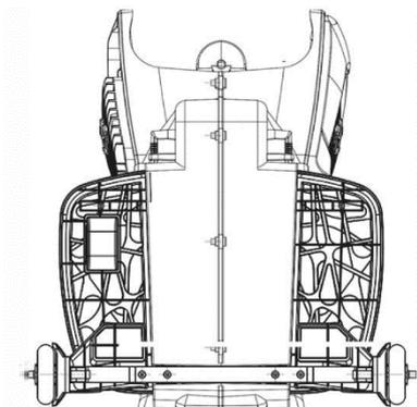
Retire el tornillo del pedal, coloque la ranura del pedal con la rueda auxiliar y fije el pedal y la rueda auxiliar con los cuatro tornillos largos azules.
