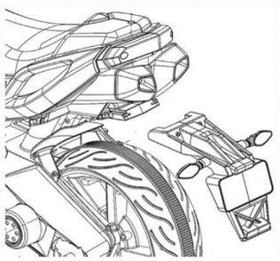
Retire el tornillo preinstalado en la parte trasera del vehículo, inserte la placa de matrícula trasera y fijela con el tornillo.
